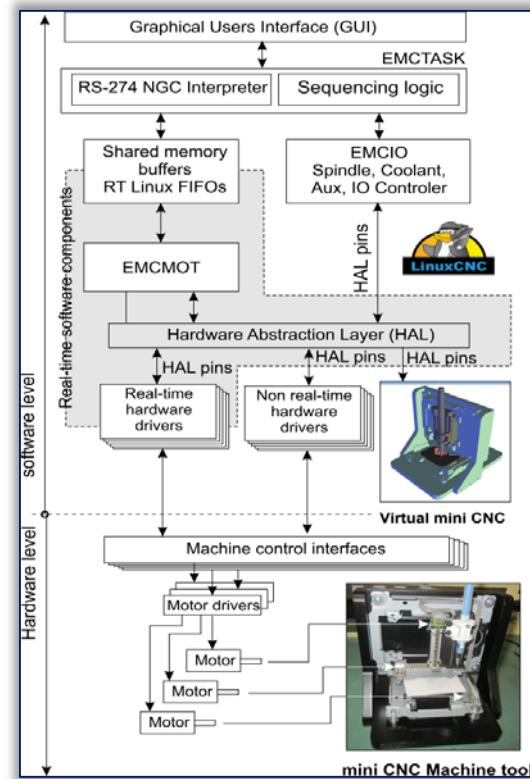
Figure 7. Architecture LinuxCNC—a for mini CNC machine tool
