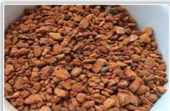
Slag (Burnt argil)
