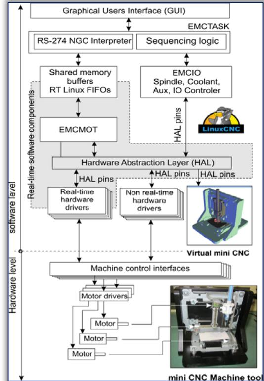
Figure 7. Architecture LinuxCNC-a for mini CNC machine tool
